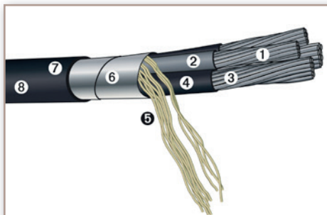
Coupe d'un câble souterrain haute tension unifilaire
