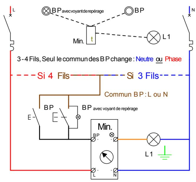
Repères Phase L, Neutre N, BP et Lampe selon constructeur: Voir schéma sur le côté de la Minuterie
