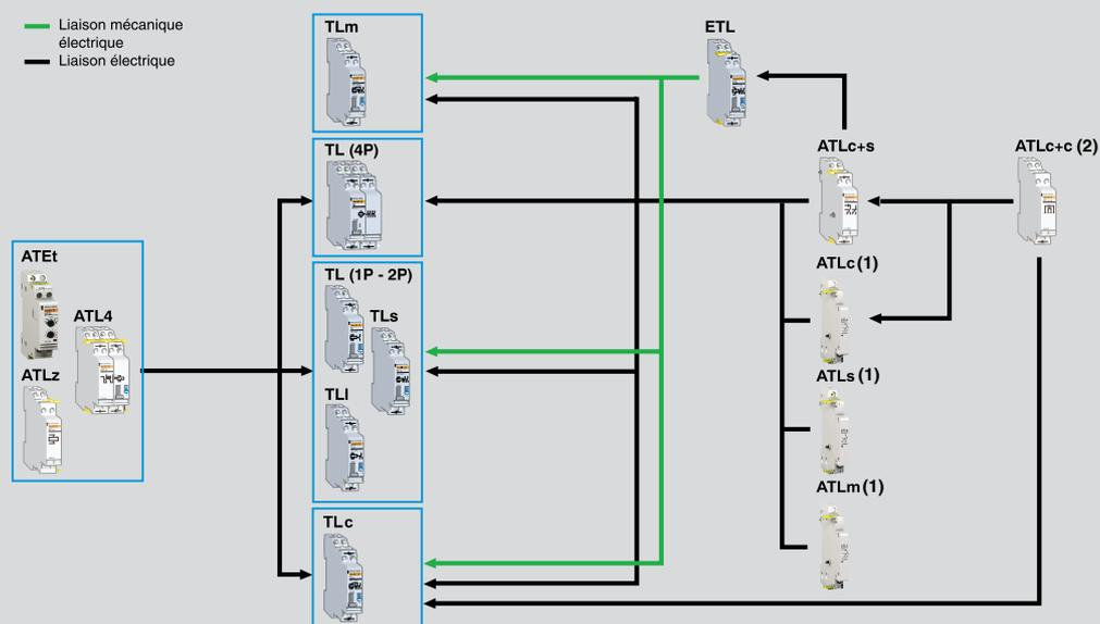
(1) Un seul auxiliaire 9 mm, ATLc, ATLs, ATLm, s'utilise à droite d'un télérupteur.
