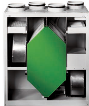
Figure 13.11 Centrale double flux : l'échangeur thermique situé au centre permet de récupérer la chaleur au lieu de l'évacuer vers l'extérieur et ainsi d'optimiser les performances énergétiques de la maison. Un système de filtrage assure la qualité de l'air insufflé dans les pièces (source Helios)
