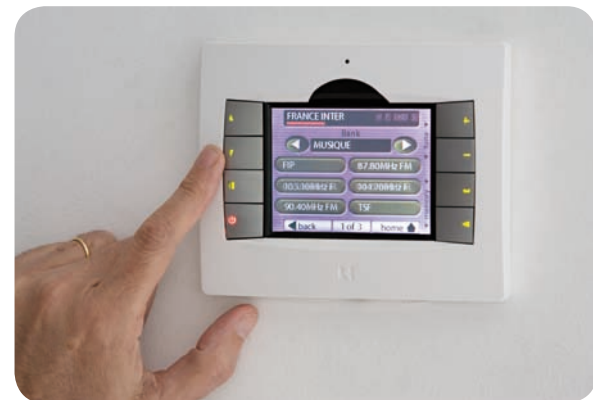
Figure 13.23 Écran tactile situé à l'entrée du salon permettant de commander toutes les sources audio et vidéo de la maison (© P. Kozłowski)
