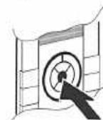
Une fenêtre de confirmation s'affiche. Le mode de programmation est activé. La station de commande IP confort est reconnue par le système KNX.
