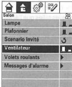
**i** La représentation et l'utilisation de mon-batiment@schneider-electric peuvent être effectuées sur différents appareils : sur les appareils mon-batiment@schneider-electric (la station de commande IP confort p. ex.) mais aussi sur un navigateur Web (PC, PDA ou iPhone, p. ex.), connectés en réseau à un appareil mon-batiment@schneider-electric.
