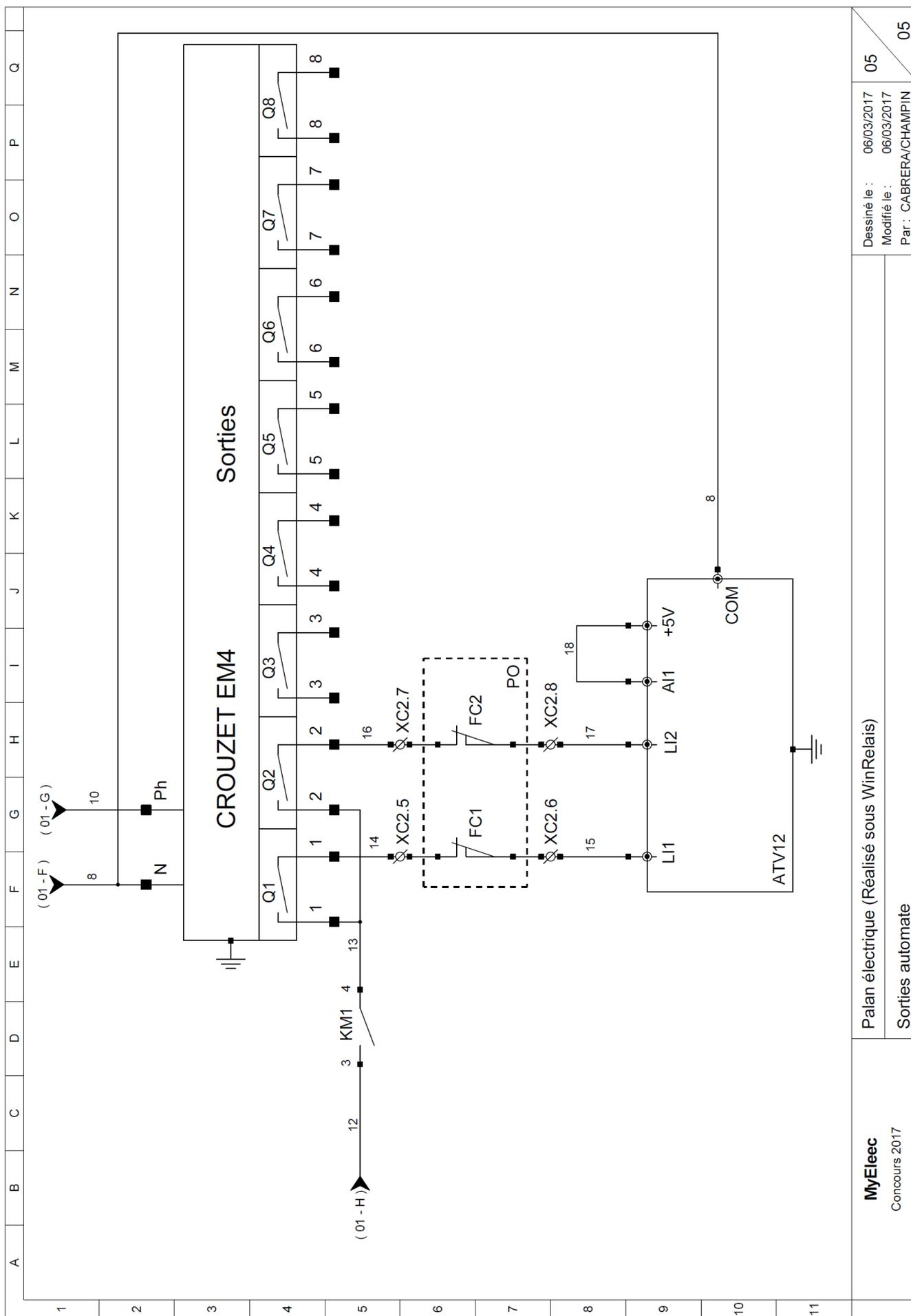
Palan électrique (Réalisé sous WinRelais)
